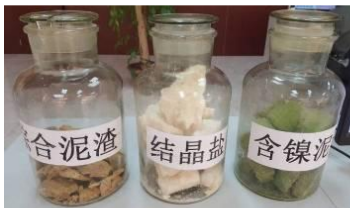
图 3.1-6 电镀污水处理产生的污泥、结晶盐及含镍污泥的照片
